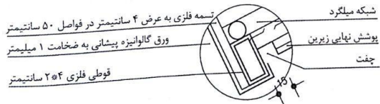
شکل (۱۷-۱۷) سقف شیبدار با پوشش پانل ساندویچی
