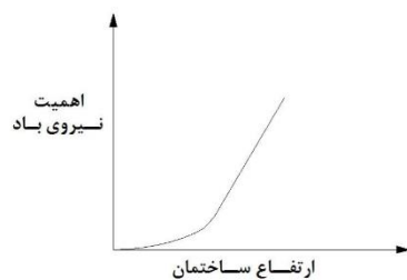
شکل ۱- رابطه بین اهمیت نیروی جانبی باد و ارتفاع ساختمان (ایروین، ۲۰۱۰)
